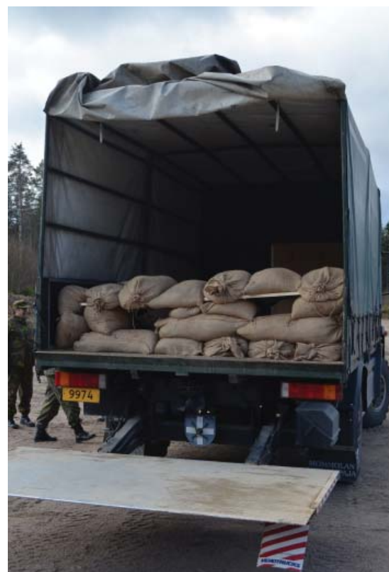
Kevät-Hälvän Pioneerikurssilla hiekasäkeistä kuorma-auton lavalle valmisteltiin raivaamisbunkkeri ampuma- ja tähystysaukkoineen.
